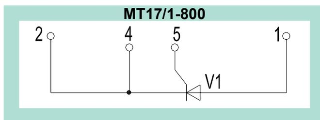
V1 - первый полупроводниковый элемент модуля
