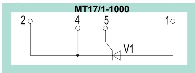
V1 - первый полупроводниковый элемент модуля
