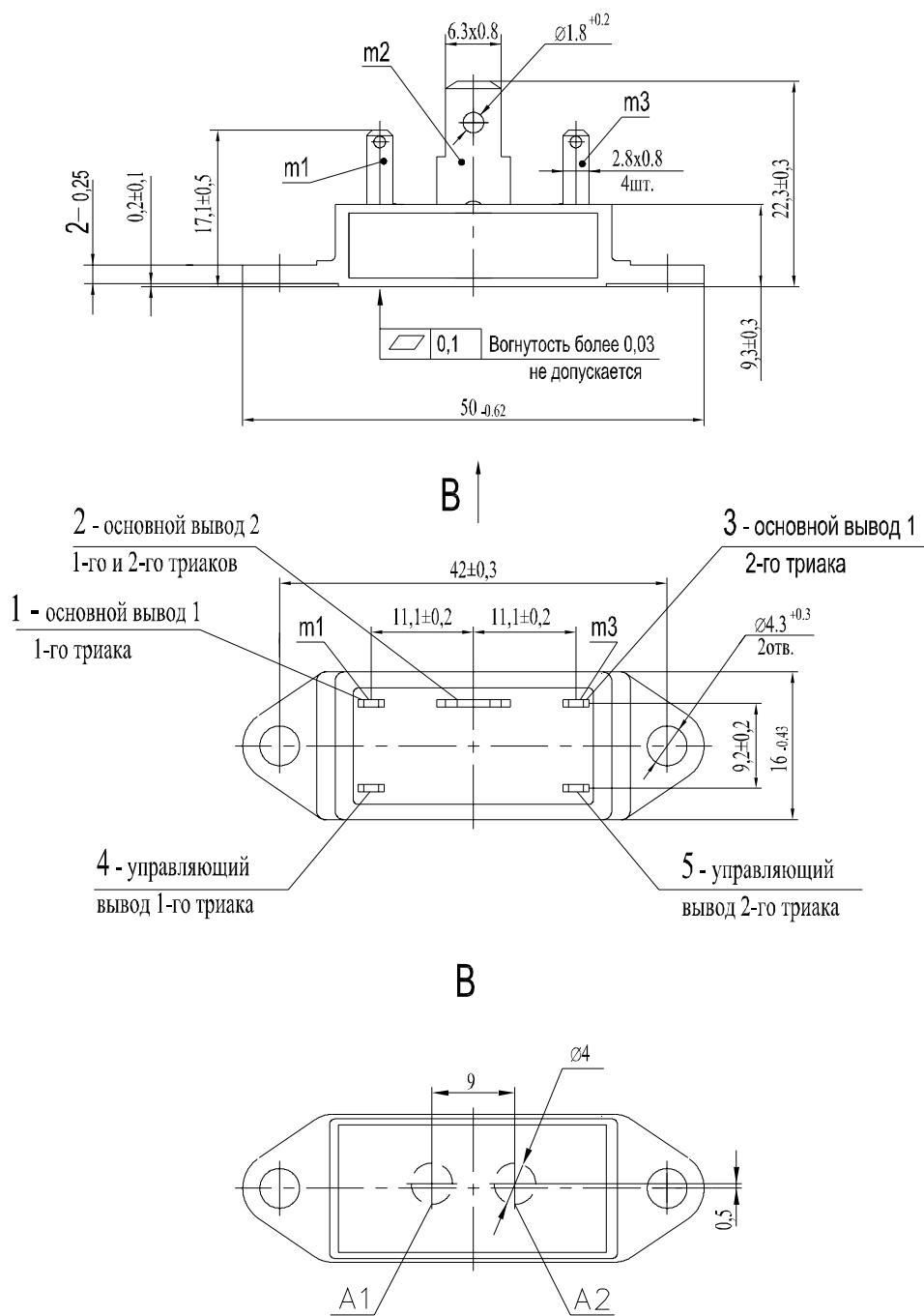
A1, A2 - области контроля температуры корпуса модуля;
