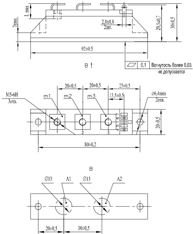
A1, A2 - области контроля температуры корпуса модуля;
