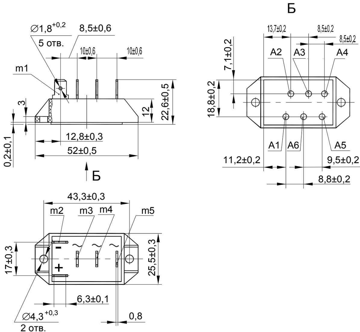
A1, A2, A3, A4, A5, A6 - области контроля температуры корпуса модуля  $\varnothing 3$  мм;
