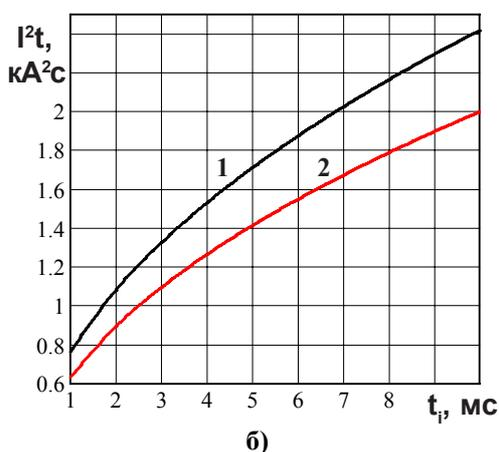
Рисунок 5 - Зависимость защитного показателя  $I^2t$  от длительности импульса тока  $t_i$  при температуре  $T_j = 25\text{ °C}$  (1) и максимально допустимой температуре перехода  $T_{jm}$  (2) для модулей: а) МДД14/3-500, МД16/1-500; б) МДД14/3-630, МД16/1-630.
