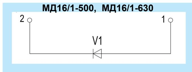
V1 - первый полупроводниковый элемент модуля
