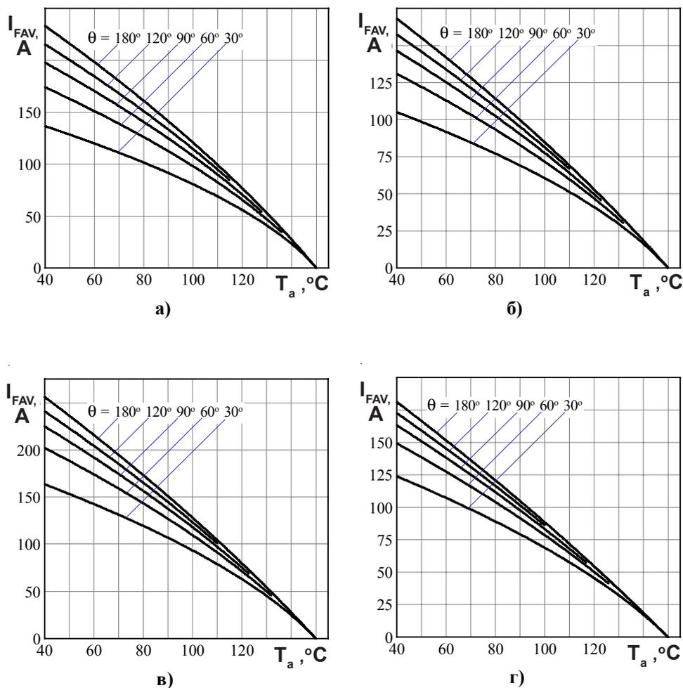
Рисунок 8 - Зависимость допустимого среднего прямого тока синусоидальной формы  $I_{FAV}$  частотой 50 Гц при различных углах проводимости от температуры окружающей среды  $T_a$  при естественном охлаждении для модулей:
