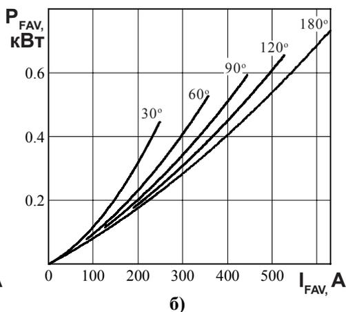
Рисунок 6 - Зависимость средней прямой рассеиваемой мощности  $P_{FAV}$  от среднего прямого тока  $I_{FAV}$  синусоидальной формы частотой 50 Гц при различных углах проводимости для модулей: а) МДД14/3-500, МД16/1-500; б) МДД14/3-630, МД16/1-630.
