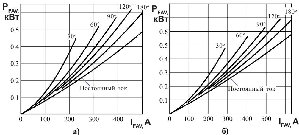
Рисунок 7 - Зависимость средней прямой рассеиваемой мощности  $P_{FAV}$  от среднего прямого тока прямоугольной формы частотой 50 Гц при различных углах проводимости и постоянного тока  $I_{FAV}$  для модулей
