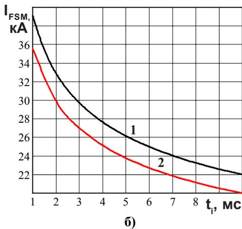
Рисунок 4 - Зависимость допустимой амплитуды ударного прямого тока  $I_{FSM}$  от длительности импульса тока  $t_i$  при исходной температуре структуры  $T_j = 25\text{ °C}$  (1) и максимально допустимой температуре перехода  $T_{jm}$  (2) для модулей: а) МДД14/3-500, МД16/1-500; б) МДД14/3-630, МД16/1-630.
